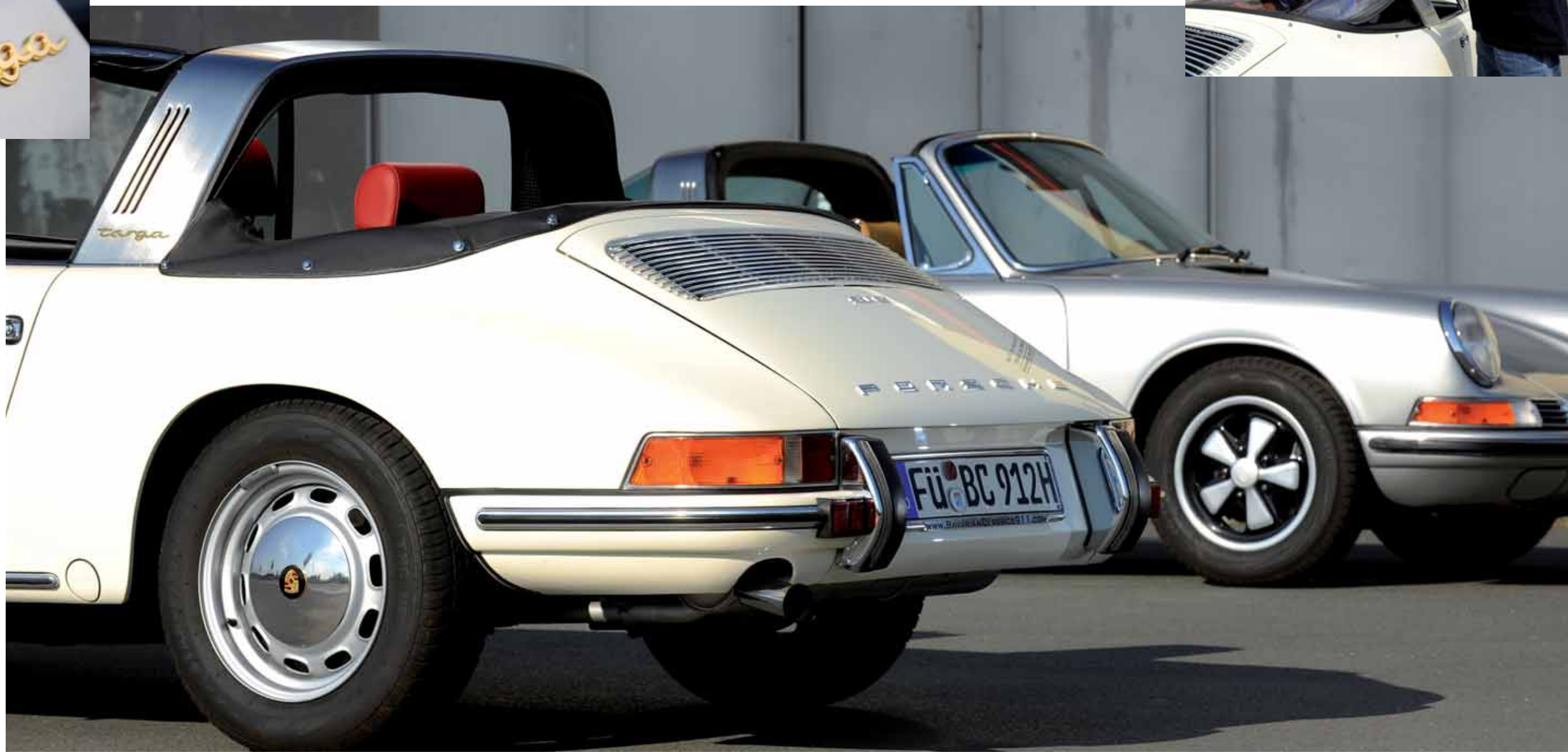
Durchgehend geöffnet: Weil kompliziert zu bedienen und in den USA nur als Zweisitzer zugelassen, wurde das Softwindow bald vom Targa mit einer Heckscheibe aus Glas abgelöst.
